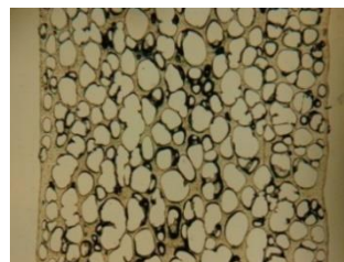
WAYMAX 発泡シート断面 (発泡倍率=3.0倍)
