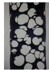
汎用PP 発泡シート断面 (発泡倍率1.8倍)
